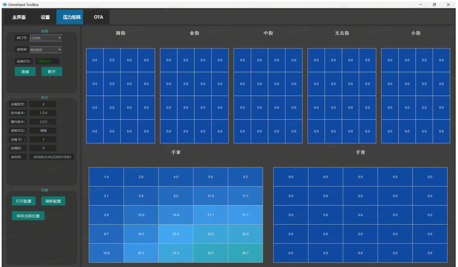
点击“压力图标”按钮，可以查看五个手指指尖、手心和手背的压力情况，其中在每个手指的指尖有16个压力测点可查看，手心和手背共有25个压力测点可查看。
