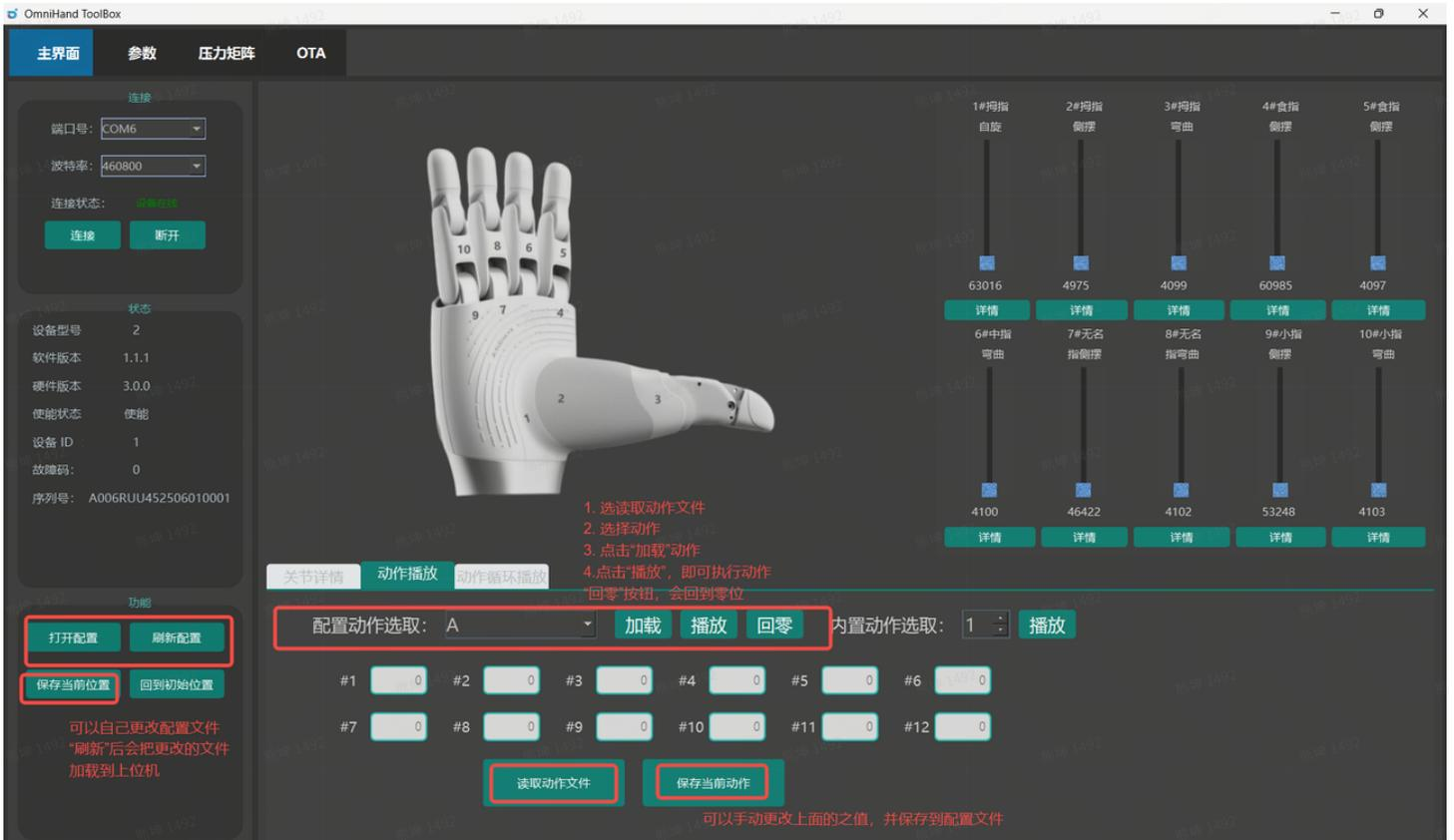
在本上位机中，可以自定义各种动作，并将当前设置好的动作姿态保存到配置文件中，以便在下次要执行动作的时候，可以一键操作。回零按钮可以让所有还可以读取已经保存的配置，加载到上位机上面，
