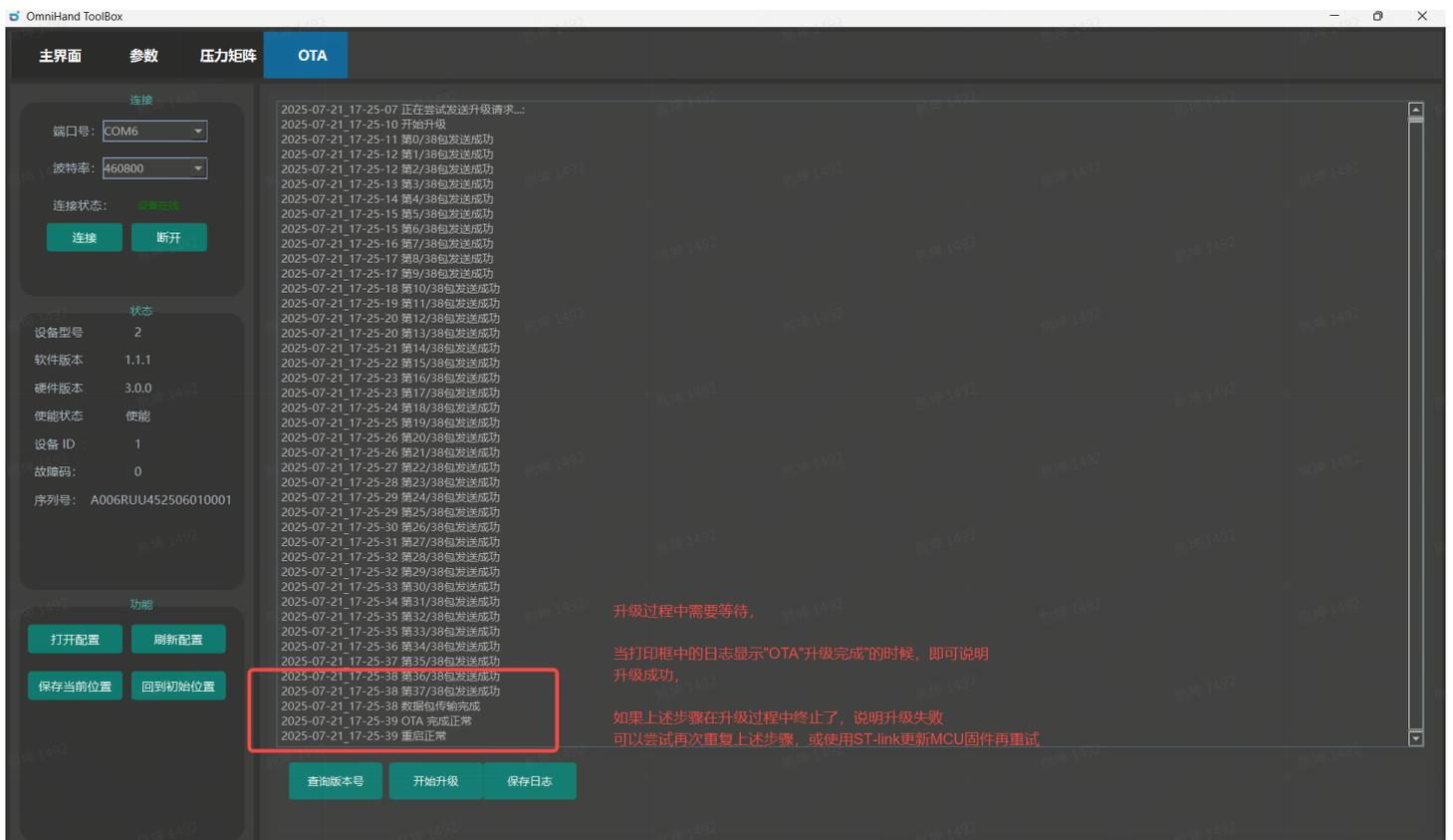
在当前“OTA”页面，当设备连接成功并显示“设备在线”后，点击“开始升级”，在弹出的选择框中选择要升级的固件bin文件，等待升级完成即可，升级过程通过日志打印，通过查看升级过程的日志可以确定升级是否成功，成功后会显示“OTA完成正常”，“重启正常”等字样。
